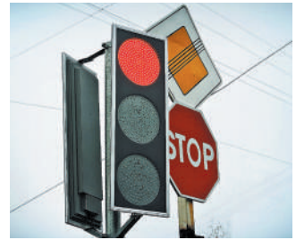
Рис. 9.3. Сигнали сучасних світлофорів добре помітні навіть тоді, коли яскраво світить сонце. У таких світлофорах лампи розжарення замінено на світлодіодні
